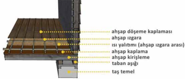
Şekil 13: Geleneksel sistem zemin kat ısı yalıtımı önerisi
