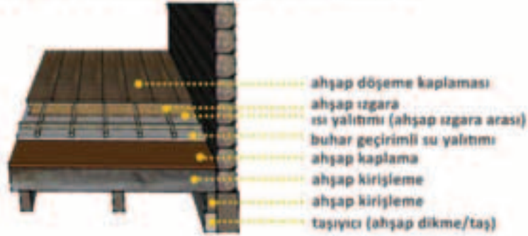
Şekil 14: Zemin kat ısı ve su yalıtımı önerisi
