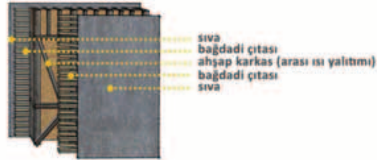
Şekil 10-11: Boşluklu ahşap karkas duvarda ısı yalıtım önerileri
